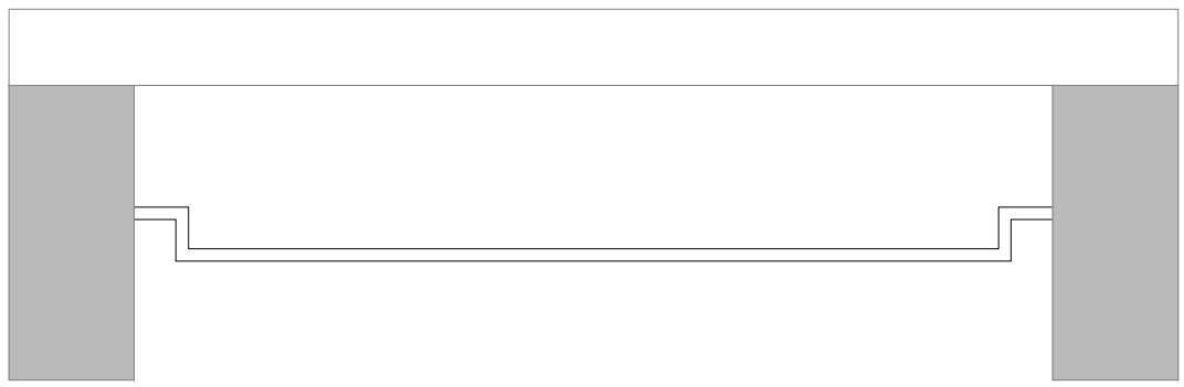
Forro com dilatação 5x5cm DET. FORRO ESCALA 1/10
