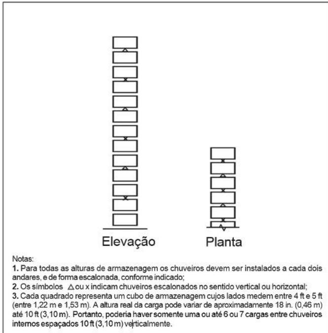
**Figura 5.3.4.4.1.2(a):** Distribuição de chuveiros internos, mercadorias Classe I, Classe II, Classe III ou Classe IV, estruturas porta-paletes simples, altura de armazenagem acima de 25 ft (7,6 m) - **Opção 1.**
