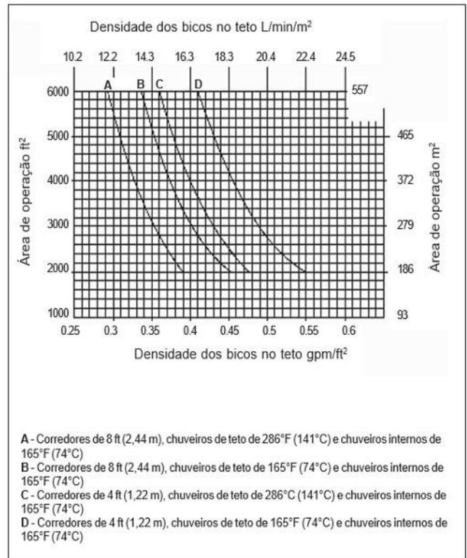
**Figura 5.3.2.1.2(g):** Estruturas porta-paletes simples ou duplas - Armazenagem a 20 ft (6,1 m) de altura em estruturas porta-paletes - Curvas de projeto de sistemas de chuveiros - Mercadoria Classe IV encapsulada - Paletes convencionais.
