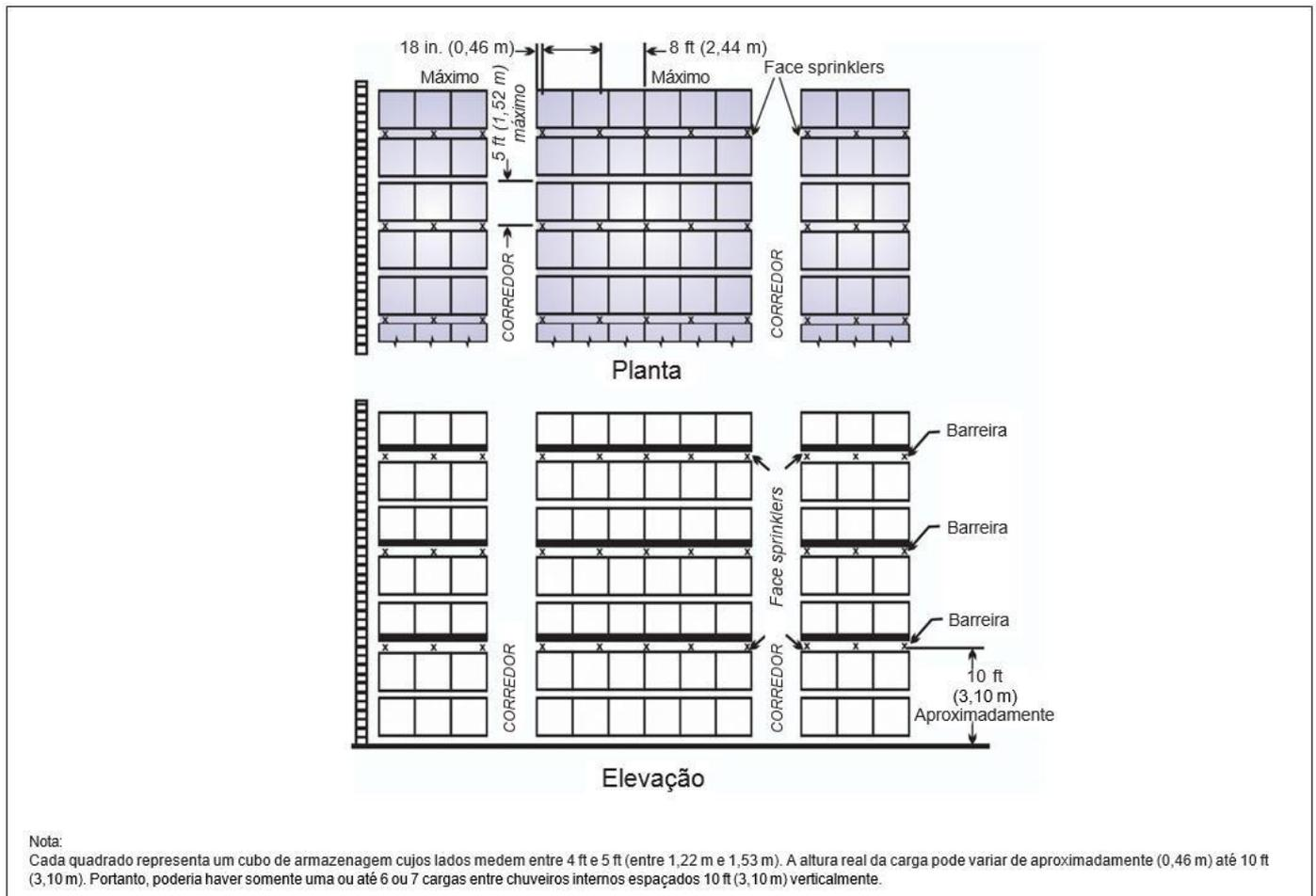
**Figura 5.3.5.4.1.3(b):** Distribuição de chuveiros internos, plásticos em caixas de papelão e plásticos não expandidos expostos, estruturas porta-paletes múltiplas, altura de armazenagem acima de 25 ft (7,6 m) - **Opção 2** [Espaçamento máximo de 10 ft (3,10)].
