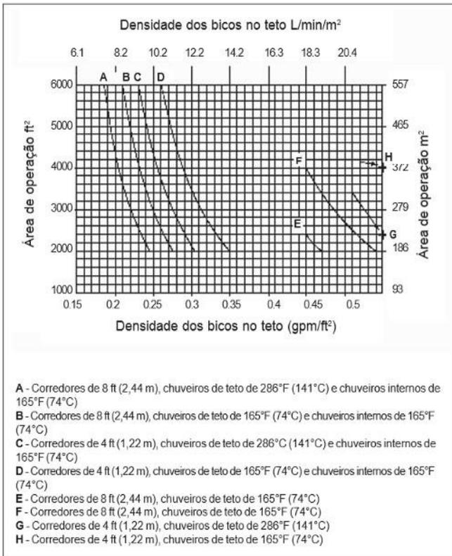
**Figura 5.3.2.1.2(e):** Estruturas porta-paletes simples ou duplas - Armazenagem a 20 ft (6,1 m) de altura em estruturas porta-paletes - Curvas de projeto de sistemas de chuveiros - Mercadoria Classe I e II encapsulada - Paletes convencionais.
