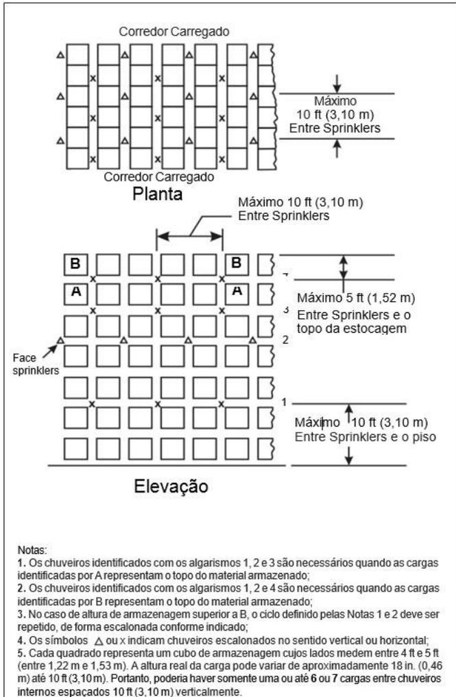
**Figura 5.3.4.4.1.3(c):** Distribuição de chuveiros internos-Estruturas porta-paletes múltiplas, mercadorias Classe I, Classe II, Classe III ou Classe IV, altura de armazenagem acima de 25 ft (7,6 m)
