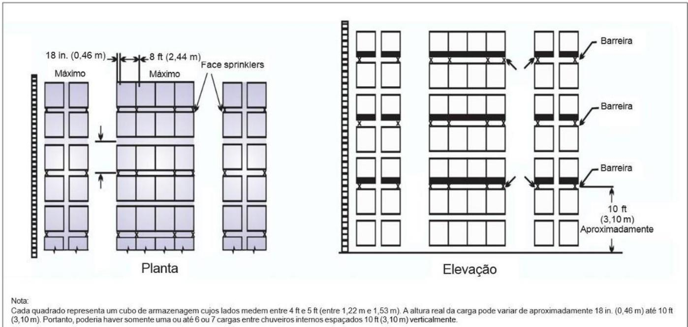
**Figura 5.3.5.4.1.3(a):** Distribuição de chuveiros internos, plásticos em caixas de papelão e plásticos não expandidos expostos, estruturas porta-paletes múltiplas, altura de armazenagem acima de 25 ft (7,6 m) - **Opção 1** [Espaçamento máximo de 10 ft (3,10)]
