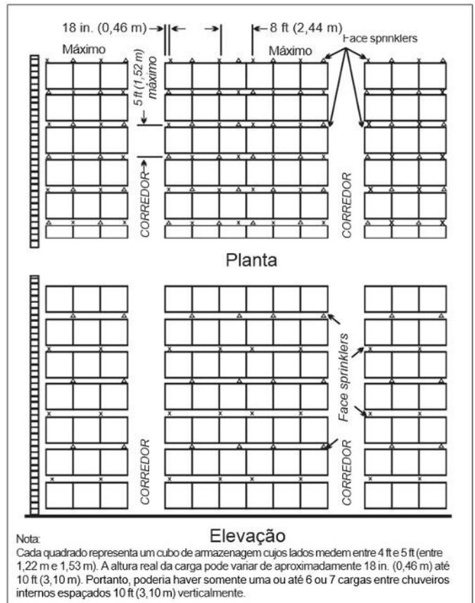
**Figura 5.3.5.4.1.3(e):** Distribuição de chuveiros internos, plásticos em caixas de papelão e plásticos não expandidos expostos, estruturas porta-paletes múltiplas, altura de armazenagem acima de 25 ft (7,6 m) - **Opção 3** [(Espaçamento máximo de 5 ft (1,5 m)]
