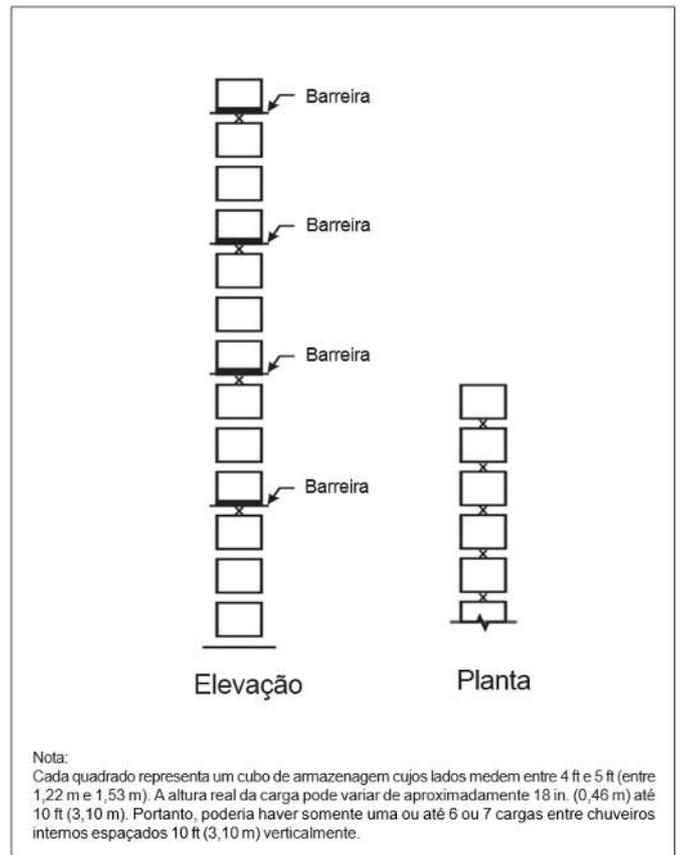
**Figura 5.3.4.4.1.2(d):** Distribuição de chuveiros internos, mercadorias Classe I, Classe II, Classe III ou Classe IV, estruturas porta-paletes simples, altura de armazenagem acima de 25 ft (7,6 m) - **Opção 2.**
