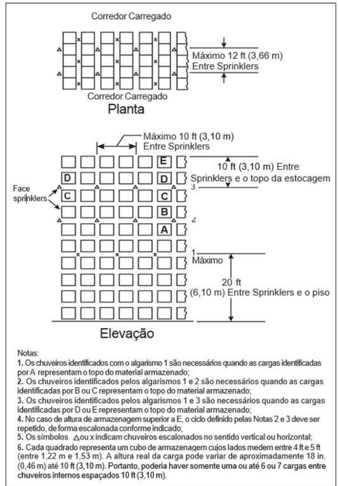
**Figura 5.3.4.4.1.2(e):** Distribuição de chuveiros internos, mercadorias Classe I, Classe II, Classe III ou Classe IV, estruturas porta-paletes simples, altura de armazenagem acima de 25 ft (7,6 m) - Opção 3.
