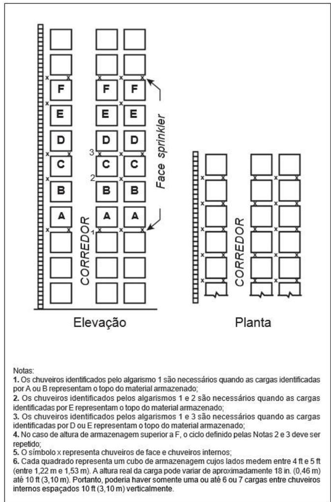
**Figura 5.3.5.1.2(b):** Distribuição de chuveiros internos, plásticos grupo A, altura de armazenagem acima de 25 ft (7,6 m) - **Opção 2.**
