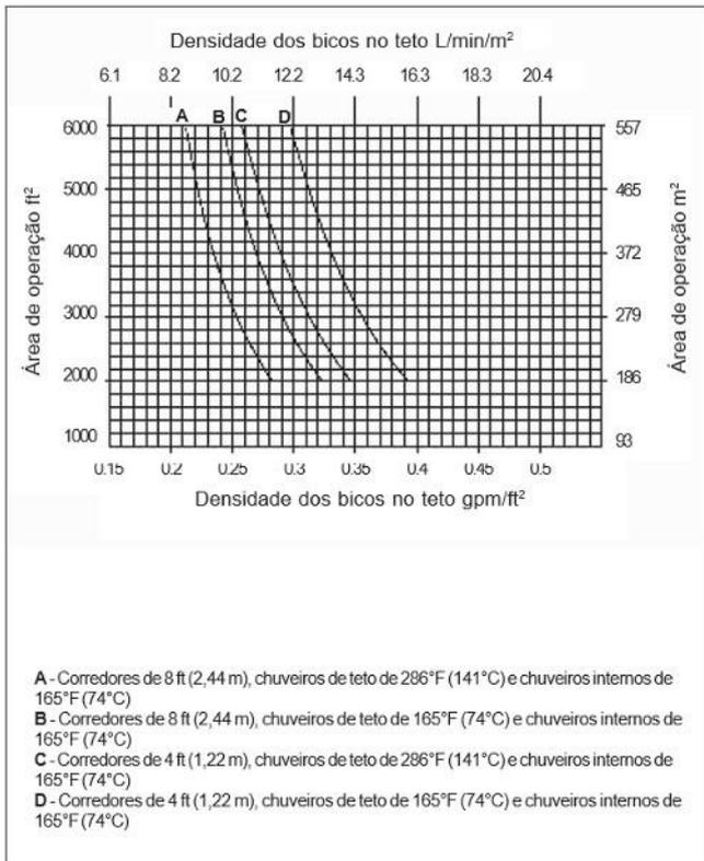
**Figura 5.3.2.1.2(f):** Estruturas porta-paletes simples ou duplas - Armazenagem a 20ft (6,1m) de altura em estruturas porta-paletes - Curvas de projeto de sistemas de chuveiros - Mercadoria Classe III encapsulada - Paletes convencionais.
