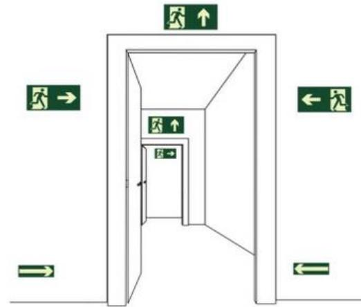
**Figura 5:** Exemplo de instalação de Placas de Sinalização acima da porta e na parede
