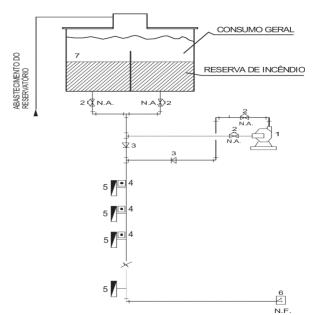
**Figura C3:** Esquema de instalação de bomba de reforço abastecendo os pontos de hidrantes ou mangotinhos mais desfavoráveis considerados no cálculo, por uma só prumada.
