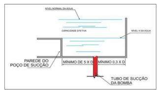
Figura B1: Tomada lateral de sucção para bomba principal.
