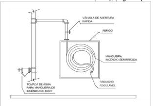
**Figura 4:** Exemplo de instalação de sistema de mangotinho com válvula globo angular na prumada, para emprego pelo Corpo de Bombeiros, em caso de uso do dispositivo de recalque da edificação
