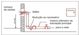
Figura 2: Dispositivo de recalque no passeio público.
