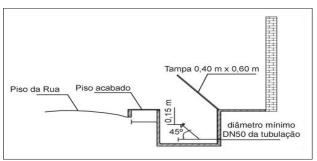
Figura 1: Dispositivo de recalque tipo coluna.
