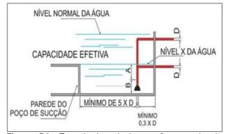
**Figura B2:** Tomada lateral de sucção para bomba principal.
