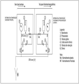
Figura C2: Cavalete de automação das bombas principal e de pressurização.
