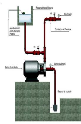
Figura C4: Exemplo de afogamento de bomba de incêndio
