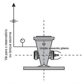
Figura C7: Arrefecimento da bomba principal elétrico
