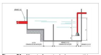
Figura B6: Alimentação natural de reservatório por conduto.
