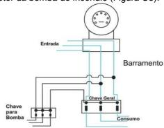
**Figura C5:** Esquema de ligação elétrica para o acionamento da bomba de incêndio
