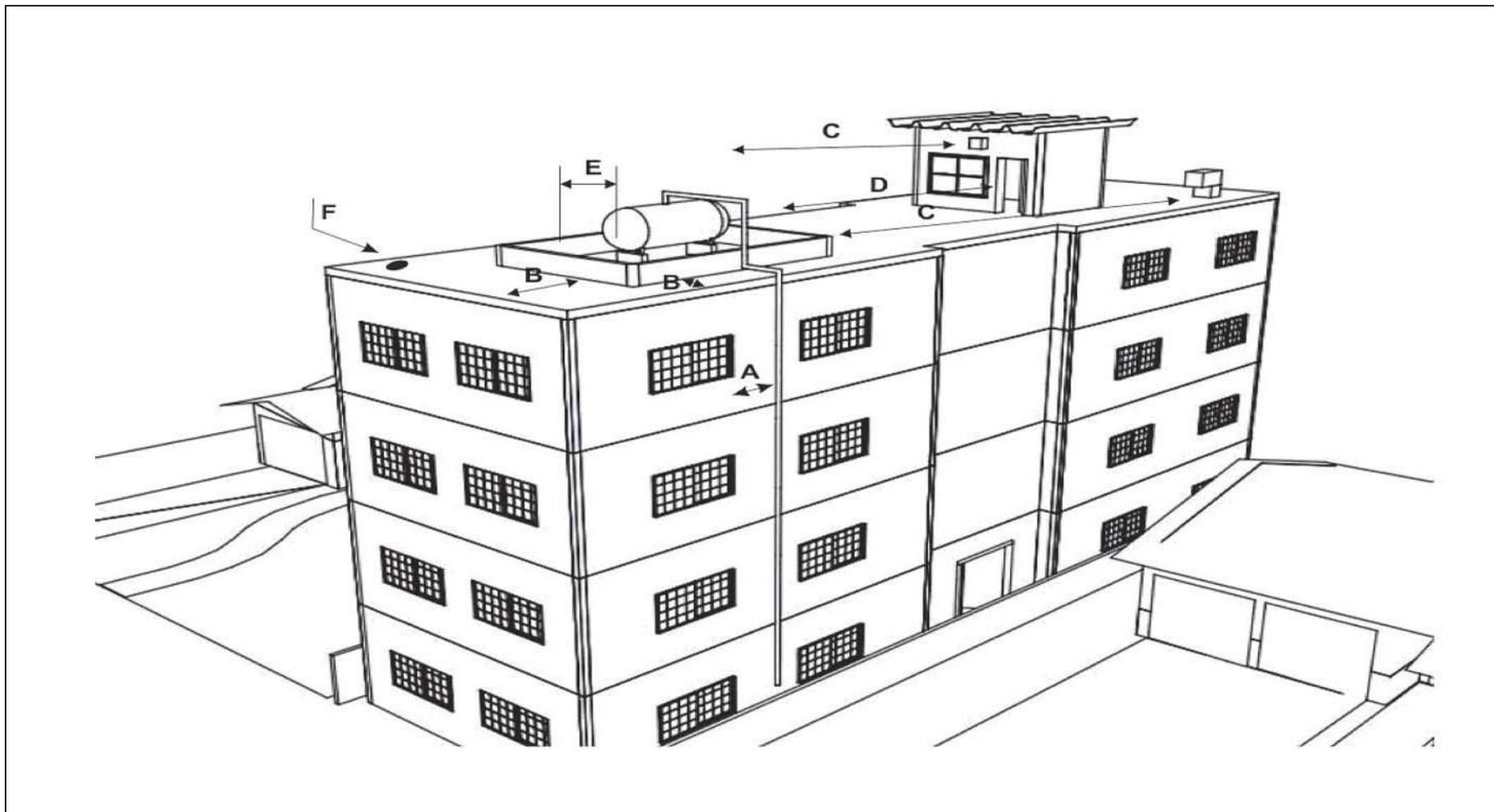
A Distância mínima da janela para: tubos com conexão roscada – 1,5 m. tubos com conexão soldada – 0,3 m.
