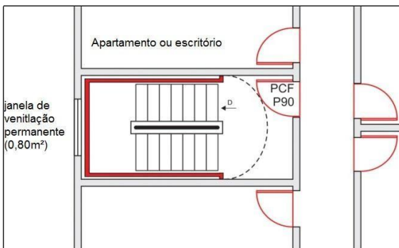
Figura 7 - Escada enclausurada protegida
