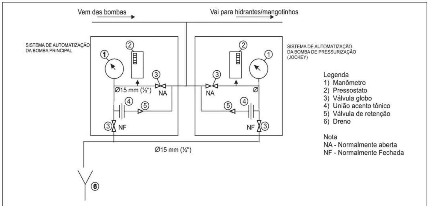
**Figura C.2:** Cavalete de automação das bombas principal e de pressurização
