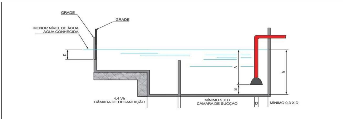
**Figura B.5** – Alimentação natural de reservatório por canal
