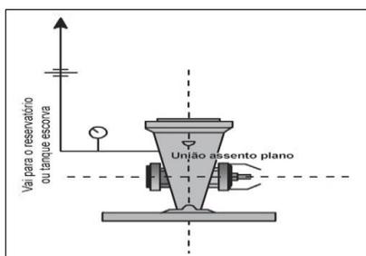
**Figura C.7:** Arrefecimento da bomba principal elétrica
