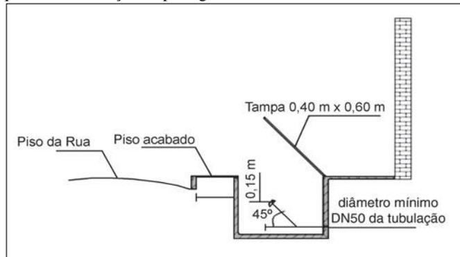
**Figura 2:** Dispositivo de recalque no passeio public
