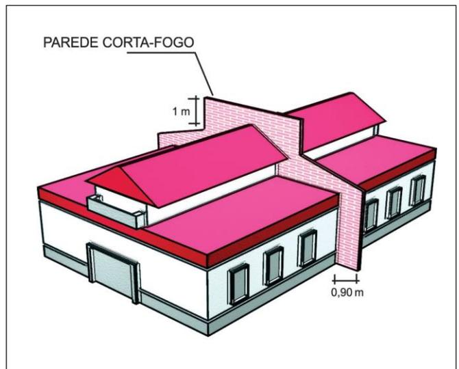
**Figura 8:** Parede corta-fogo
